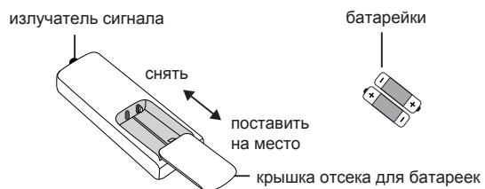
1. Нажмите на заднюю часть пульта дистанционного управления, отмеченную знаком OPEN, как показано на рисунке, и сдвиньте крышку отсека для батареек в направлении стрелки.
