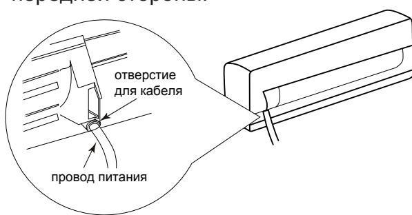
3. Снимите зажим для провода; подключите шнур питания к клемме проводки согласно цвету; затяните винт, а затем закрепите шнур питания зажимом.
