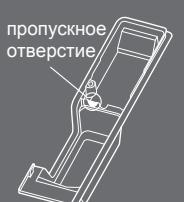
2. Снимите откручивающуюся крышку клапана и направьте соединение трубы в раструб.
