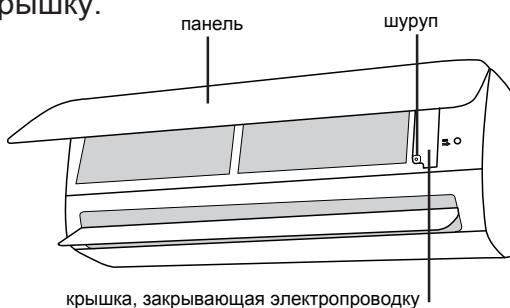
2. Проденьте провод питания через отверстие для кабеля на задней стороне внутреннего блока, а затем вытяните его с передней стороны.
